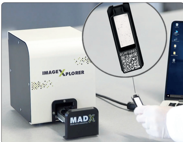
Abb. 1 Die Allergen-IgE-Antikörper-Reaktion wird anhand der colorimetrischen Spots auf dem Biochip ausgewertet. Die Intensität der Signale ist proportional zur Anzahl der spezifischen IgE-Antikörpern die an das Allergen gebunden sind.
